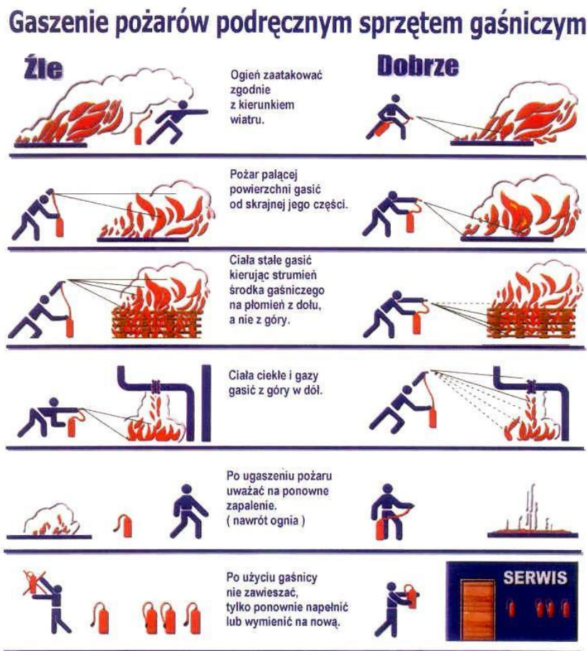
Rys. – podstawowe zasady gaszenia pożarów
